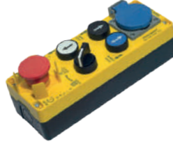
MS-LV5 YUKARI (1NO) ORTAK (1NO) AŞAĞI (1NO) 0-1 REVİZYON (1NO) ACİL STOP BUT. (1NC) 16A KAP. PRİZ EL TERMİNALI UP (1NO) COM. (1NO) DOWN (1NO) 0-1 REVISION (1NO) EMER. STOP (1NC) 16A COVERED SOC. (REMOTE CON.)
